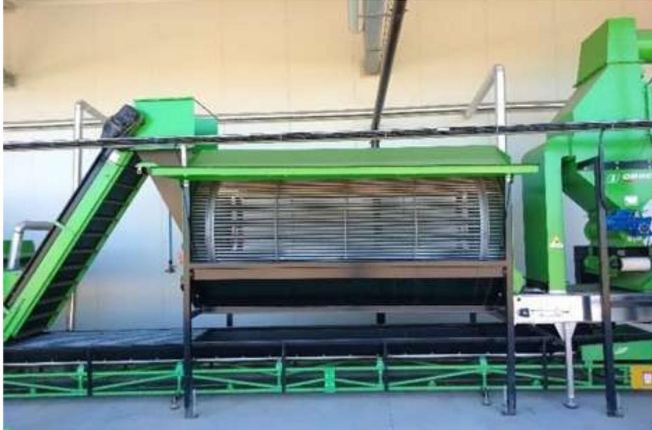
Considerato che la macchina Obreo necessita di una portata di acqua costante e definita che non può essere diminuita senza pregiudicare la qualità del prodotto finito, la sperimentazione prevede il parziale riutilizzo delle acque scaricate dalla macchina, previa separazione delle sostanze indesiderate. In tal modo si conta di conseguire un risparmio idrico di circa il 50-70%.
