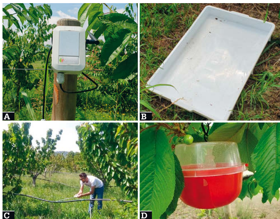
Foto A Sensori per il rilevamento del microclima. Foto: S. Caruso. Foto B Vasca per la raccolta e misurazione dell'impermeabilità delle coperture. Foto: S. Caruso. Foto C Misura della intercettazione luminosa con ceptometro AccuPAR LP-80. Foto L. Manfrini. Foto D Trappola per il monitoraggio di Drosophila suzukii . Foto: S. Caruso.
