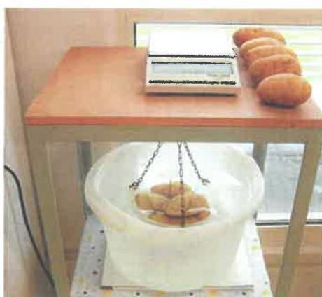
**Foto 2** Pesatura dei tuberi in aria (a sinistra) e in acqua (a destra) per il calcolo della sostanza secca
