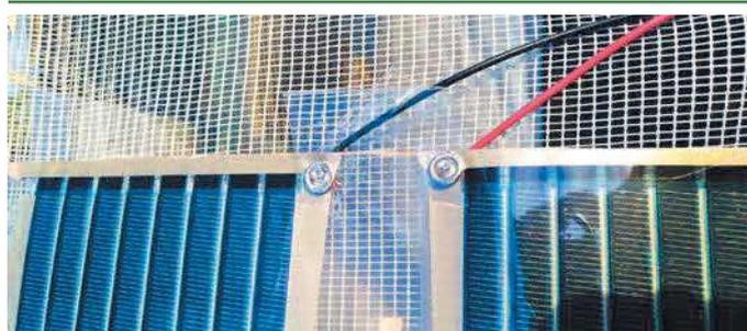
F Particolare del collegamento per misurazione
