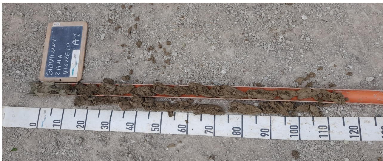
Trivellata eseguita nel vigneto coperto da 15-20 cm di fango umido. Suolo umido in tutti gli orizzonti. Non sono presenti colori o processi di riduzione.
