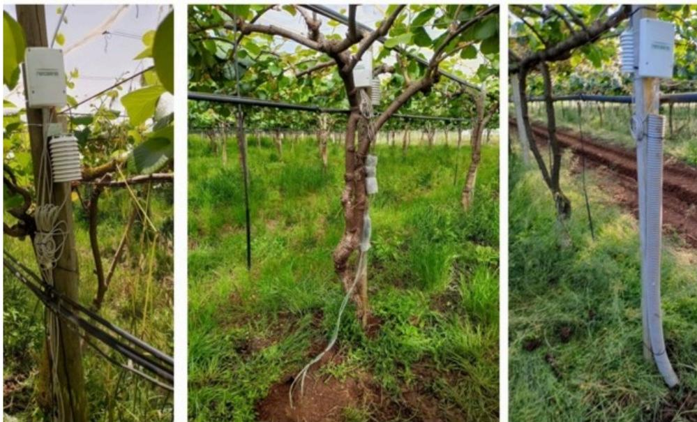
*Esempi di unità wireless installate all'interno di impianti di kiwi, per il monitoraggio delle condizioni micro-climatiche a livello della chioma e del contenuto idrico del suolo a varie profondità*
