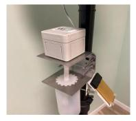
Fig. 2. Termometro a bulbo umido
