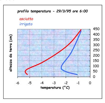
Fig. 5. Variazione del profilo delle temperature per effetto dell'irrigazione antibrina sottochioma, rispetto alla zona non protetta.
