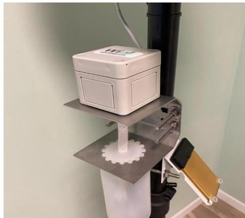
*Fig. 3. Termometro a bulbo umido*
